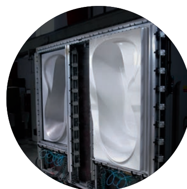
Штамповочный цех RAVAK Изготовление штампованного изделия будущей акриловой ванны с помощью технологии вертикального нагрева.
