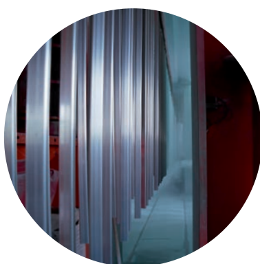
Лакировочный цех RAVAK Электростатическое нанесение порошковой краски на алюминиевые профили душевых уголков, дверей и шторок для ванн.
